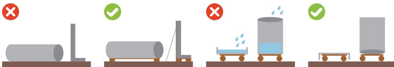
Figura 10 - O material sem contato direto com o solo e sem possibilidade de acúmulos de água.
