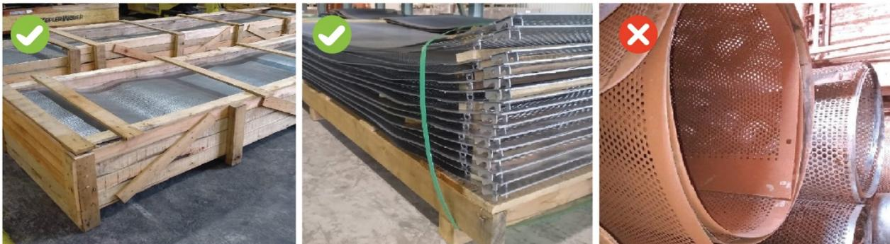
Figura 21 – Estocagem das peneiras de maquinas de Limpeza MLR.
