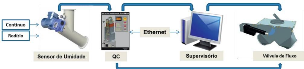
A descarga automática do secador controla a velocidade para estabilizar a umidade dos grãos. Assim, a sua produção fica na condição ideal para ser armazenada.
